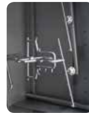
Conjunto de inyectores distribuido para alcanzar todas las áreas de lavado. Set of nozzles distributed to reach all areas to be washed.
